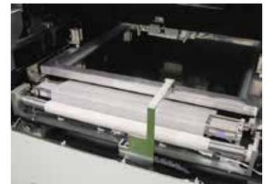
采用干湿一体式清洁机构缩短清洁动作，从而大幅减少保养时间。另外，清洗剂的滴落范围可根据电路板的宽度自动调整，因此能用最少量的清洗剂达到最理想的清洗效果。
