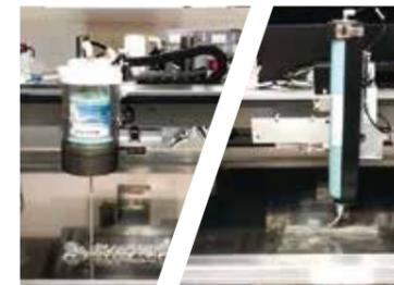
检测锡膏量，在必要时自动供应锡膏。始终保持在理想的锡膏量下印刷，实现稳定的品质。直接用罐装或筒装锡膏来进行生产。由此可在短时间内准确无误地完成更换作业。
