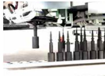
自动将支撑销正确配置到事先设置的位置上。换线作业的自动化有助于削减操作员的作业工时，并防止由人为失误引起的不良电路板。
