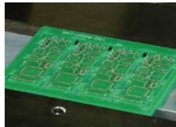
通过可根据电路板特性选择最佳夹紧方式(侧面/上面/边缘)的混合夹紧机构，可实现夹持的稳定。
