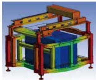
由于从底座到印刷机构都采用了高刚性的机械设计，所以实现了对应精细图形(0201元件)的高水准印刷性能。还具备从小型到超大型电路板的生产对应能力，以及维持印刷品质的耐久性。
