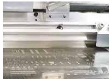
由于每台印刷机都标配测力传感器，所以可以根据电路板或钢网的凹凸情况对印压进行实时监控并及时调整。即便是受重量以及长度影响而很难均匀填充锡膏的刮刀，也能始终维持最适合的锡膏填充量。
